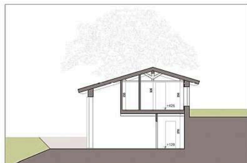
Sezione B-B' scala 1:100
