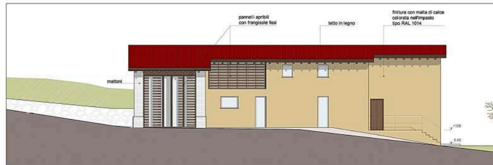
Prospetto nord-est scala 1:100
